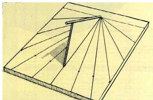
7 Orientez l'instrument pour que le style soit dans l'axe nord-sud en vous servant d'une boussole. Rappelez-vous que la boussole pointe vers le nord magnétique et que vous devrez corriger la déclinaison magnétique.
